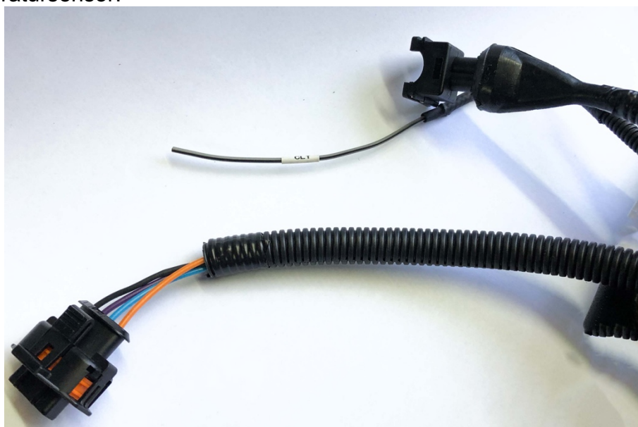
Stecker für Leerlaufregelventil, Stecker für MAP Sensor und Kabel für zweipoligen Kühlmitteltemperatursensor:
